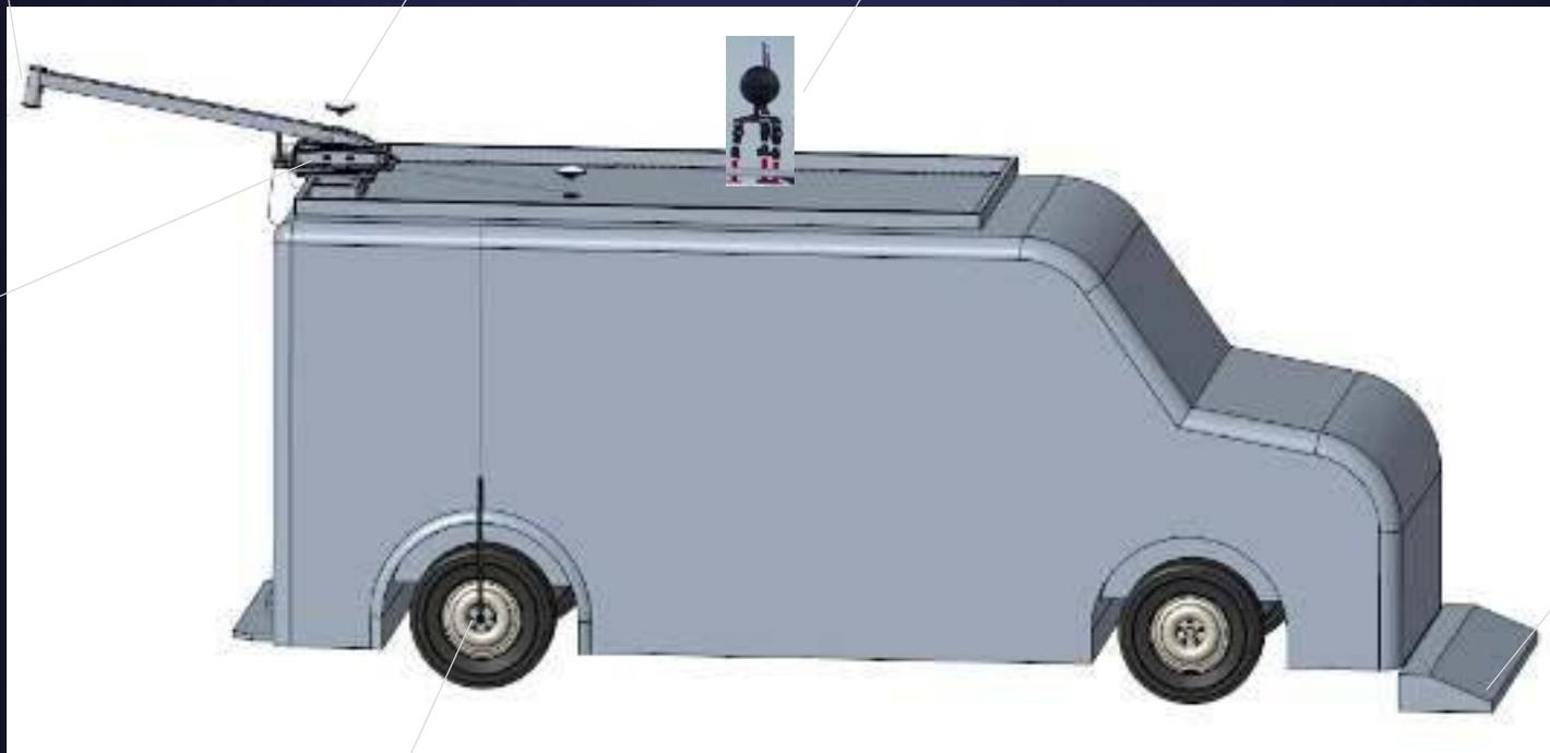
车轮编码器/三轴加速度传感器
