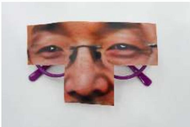
清华的 RealAI (瑞莱智慧) 团队选取了 20 款手机做了人脸识别攻击测试。除搭载了3D 摄像头和活体检测技术的iPhone 11未被破解外，其余19款收集均被破解。原因是：人脸识别系统的手机均使用 2D 摄像头，采用单个摄像头提取到人脸特征，基于二维图像识别解锁，在某些场景下很容易被攻破。
