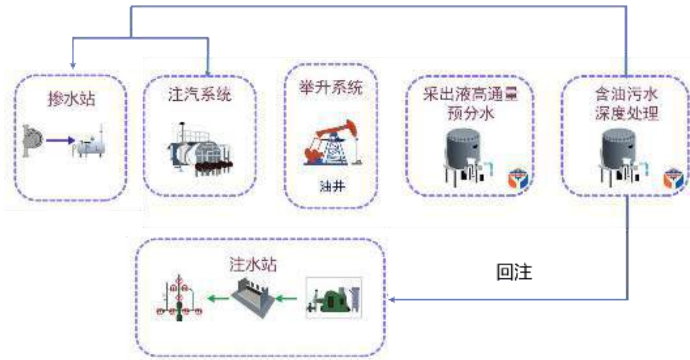
采出液短流程工艺流程图
